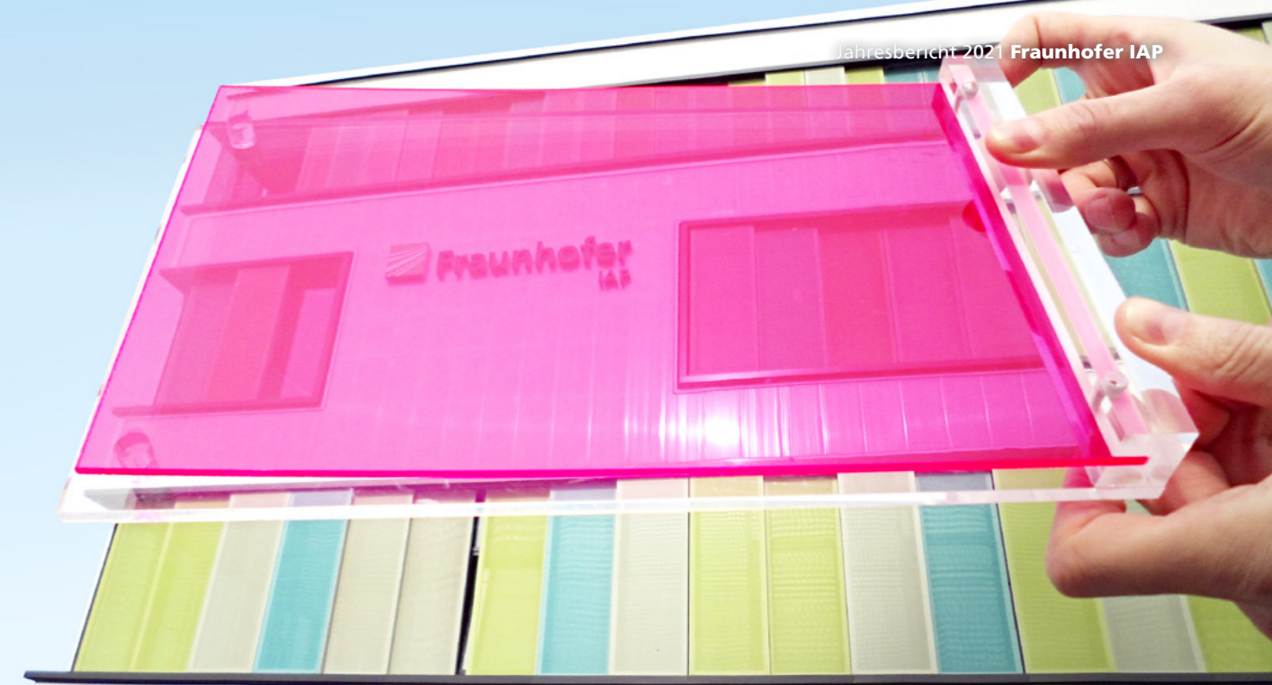
Lumineszente Nanopartikel in einer Polymer- matrix konvertieren das Sonnenlicht in Strom.
