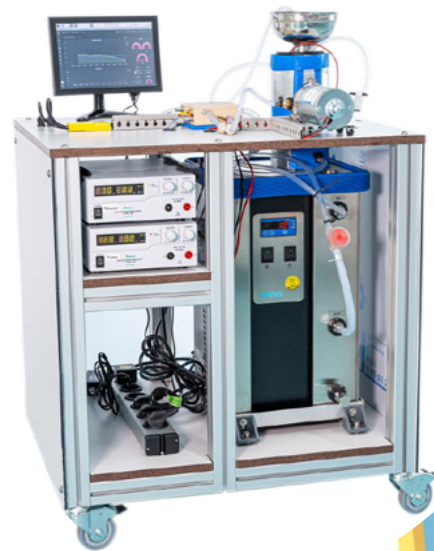
Mobile Reaktoranlage für den Vor-Ort-Einsatz.
