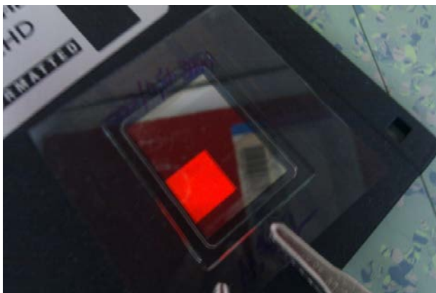
Bild 13: Quantum Dot OLED mit vernetzbarer Lochtransportschicht, entwickelt im Projekt.
