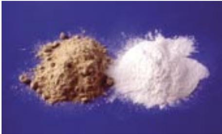
Bild 1 Haferspelzen (links) und daraus hergestelltes Carboxymethylxylan (rechts).
