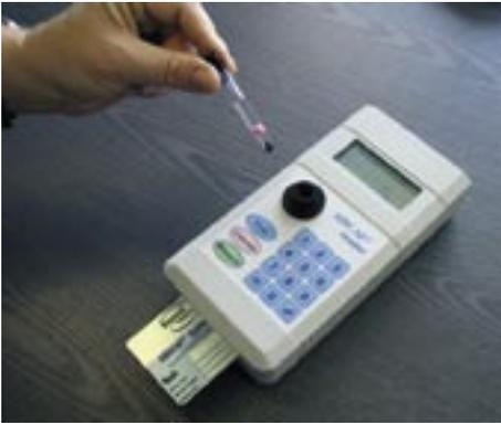
Bild 1 Abicap®-System mit beladener Fritte und Reader (Quelle: Biognosis GmbH).
