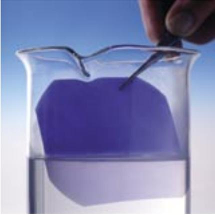
Bild 1 Farbschaltung einer Polymerfolie von Blau nach Farblos bei Erwärmung.
