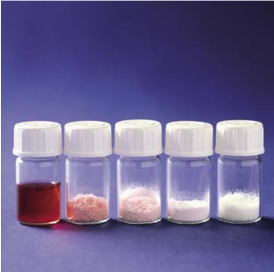
Die von links nach rechts abnehmende Farbintensität der Proben spiegelt die wachsende Molmasse mit wachsendem Umsatz wieder. Die rote Färbung zeigt an, dass das aktive Zentrum erhalten bleibt und z.B. für die Synthese von Block-Copolymeren zur Verfügung steht.
