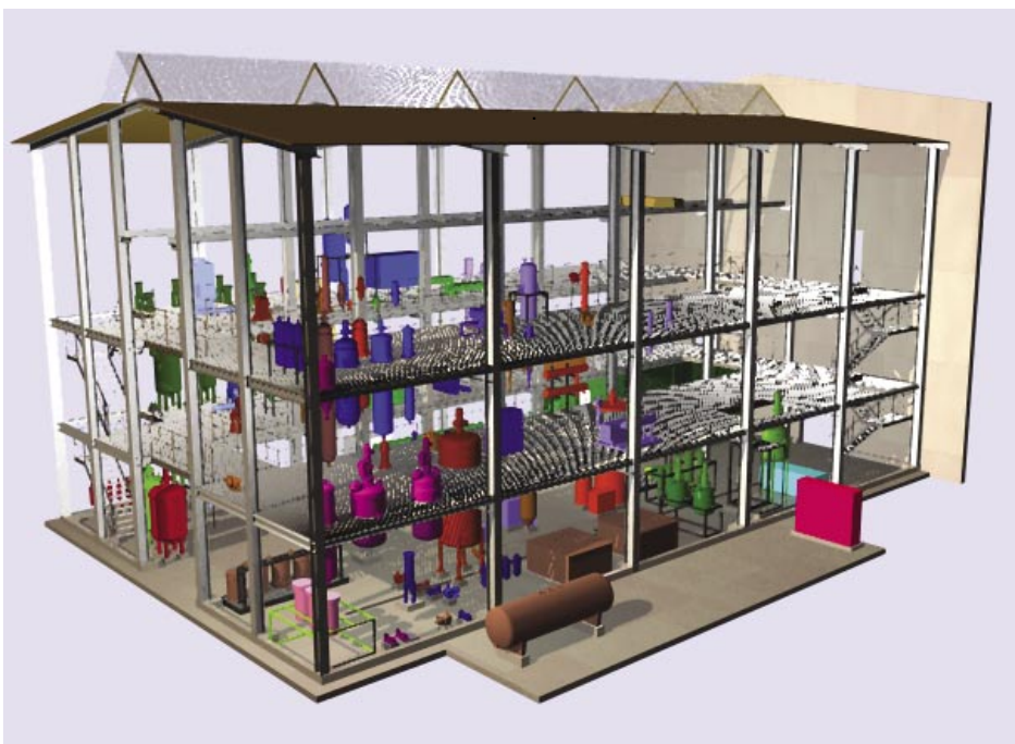
Bild 4: Aufstellungsplan der Hauptausrüstungen im Synthesetechnikum (3D-Modell), Nordseite im Hintergrund, Südseite im Vordergrund.
