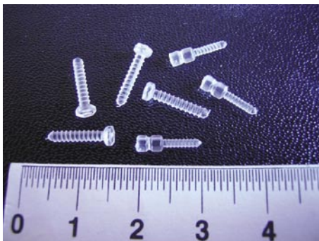
Abb. 3 Schrauben aus einem Poly(L-co-D,L-lactid) für die Befestigung von Knochenimplantaten
