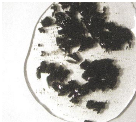
Abb. 3 Klärschlamm geflockt nach Behandlung mit dem neuartigen PolyDADMAC
