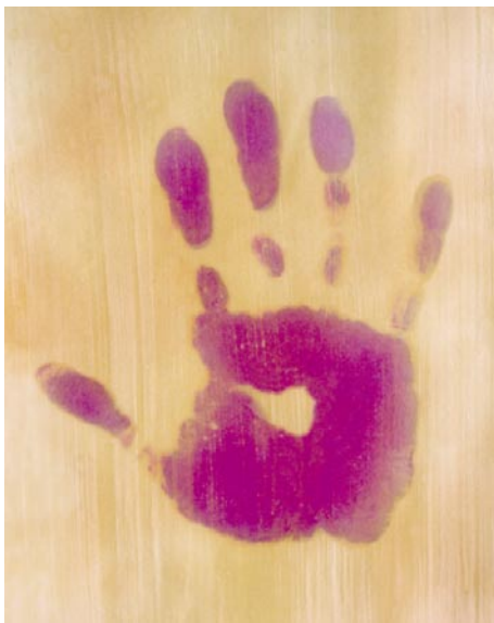
Abb. 1 Irreversible thermochrome Schaltung durch die Körperwärme einer aufgelegten Hand
