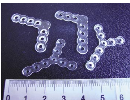
Abb. 4 L- und Y-Lochplatten für die Knochenfixierung aus einem Poly(L-co-D,L-lactid)
