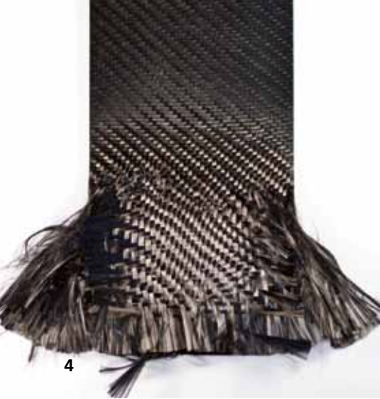
4 CFK-Laminat mit aufgelöster Matrix
