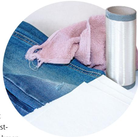
Das aufgespulte Viskose-Filamentgarn wurde aus recycelter Baumwolle gefertigt.
