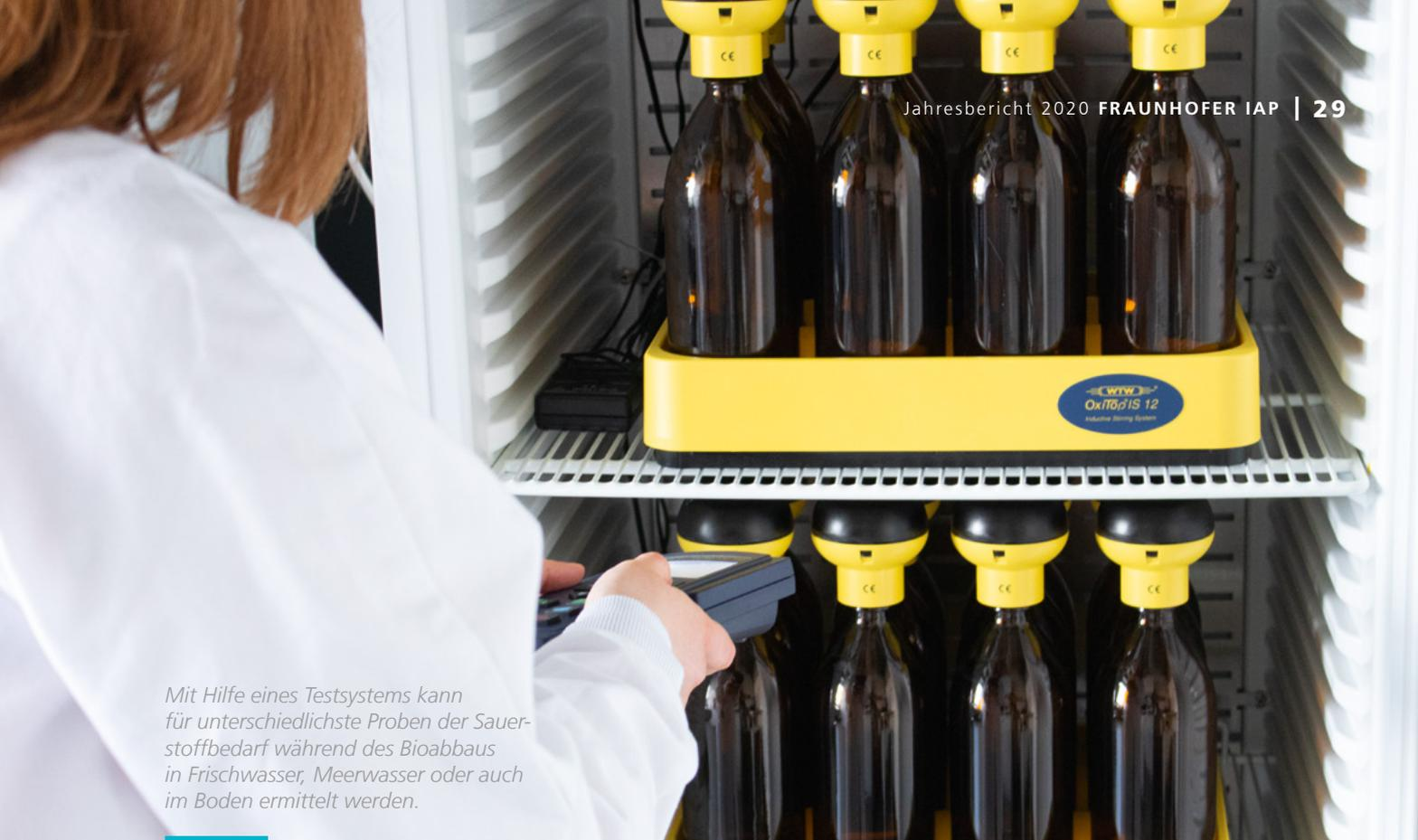
Mit Hilfe eines Testsystems kann für unterschiedlichste Proben der Sauerstoffbedarf während des Bioabbaus in Frischwasser, Meerwasser oder auch im Boden ermittelt werden.
