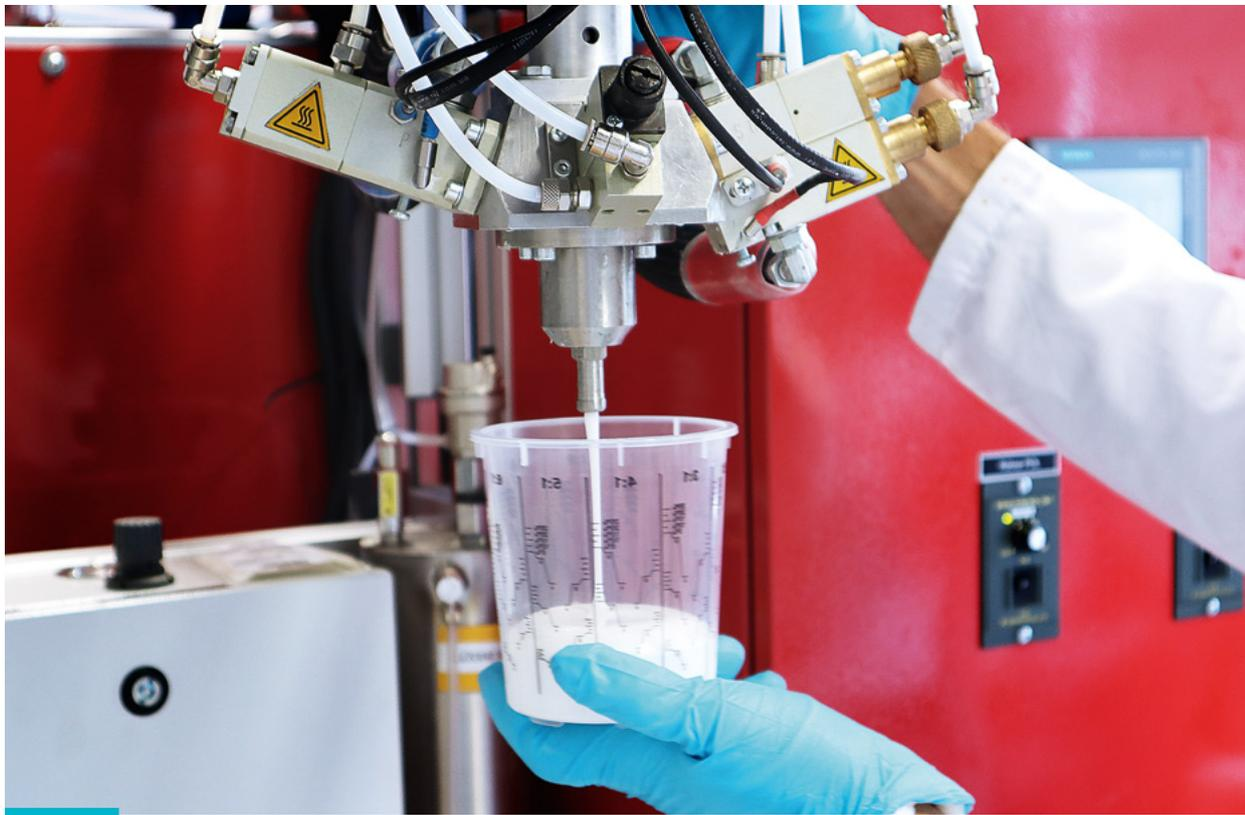
Die synthetisierten Formgedächtnispolymere werden mit speziellen Reaktivschäumen hergestellt.
