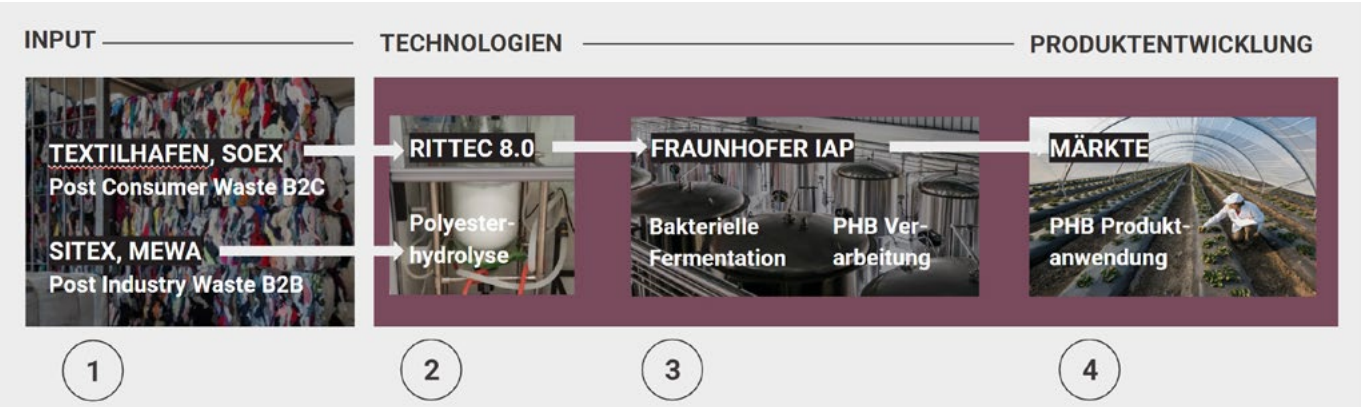
Abbildung 1 Transformationsprozess von Textilabfallfraktionen – Post-Consumer- und Post-Industry- Textilien der untersten Abfallkategorie – in Polyhydroxybutyrat (PHB) durch Polyester-Hydrolyse und bakterielle Fermentation
