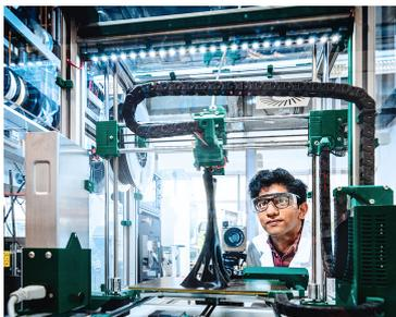
Gedruckte Kunststoffe, die bei Erwärmung in vorab festgelegter Weise einmalig ihre Form ändern? Möglich macht das eine 4D-Druck-Technologie, die im Fraunhofer Cluster of Excellence Programmable Materials CPM entwickelt wurde. Das Ausmaß der Formänderung der gedruckten Objekte ist drastisch: sie können um bis zu 63 Prozent schrumpfen.
